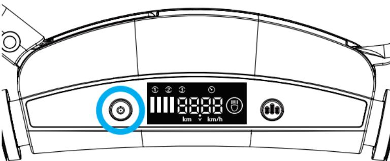
Для включения электросамоката на панели управления кратковременно нажмите кнопку, после чего раздастся звуковой сигнал и на экране панели управления отобразится информация о скоростном режиме, уровне заряда аккумуляторной батареи и показания общего пробега. Для отключения электросамоката нажмите и удерживайте кнопку до звукового сигнала.
