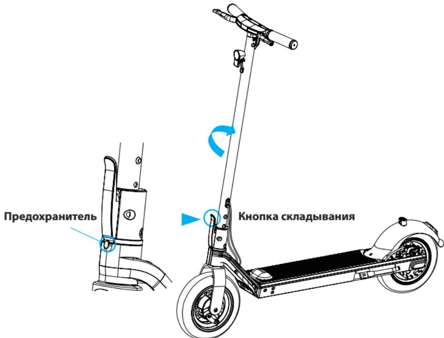
2. Зафиксируйте рулевую колонку с помощью механизма фиксации относительно заднего крыла.
