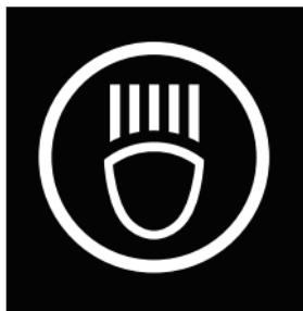
Включение и отключение освещения и габаритных огней осуществляется при условии, что электросамокат включен и готов к эксплуатации. Для включения/отключения освещения нажмите и удерживайте правую кнопку на панели управления до звукового сигнала (~1 сек.), после чего на информационном дисплее отобразится символ, показанный на рисунке выше, означающий включение освещения и габаритных огней.
