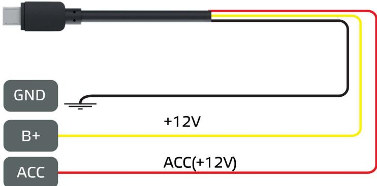
Где: GND – масса автомобиля, ACC – питание, которое подается при работающем двигателе, B+ – питание от аккумулятора.
