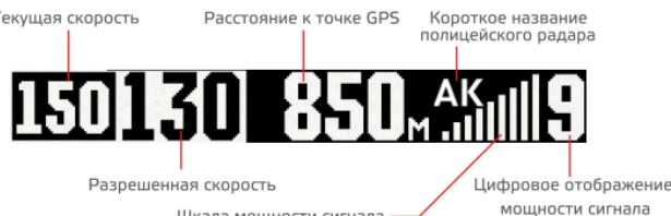
**ПРИМЕЧАНИЕ:** во время пребывания в зоне контроля средней скорости автомобиля, на дисплее радар-детектора, значение текущей скорости попеременно меняется со значением средней скорости автомобиля.
