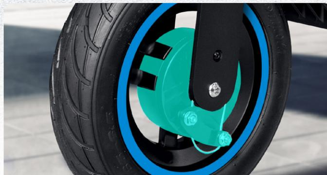
Передний тормоз барабанного типа + электронный
