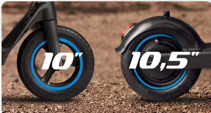
Переднее колесо 10" камерное, заднее 10,5" бескамерное
